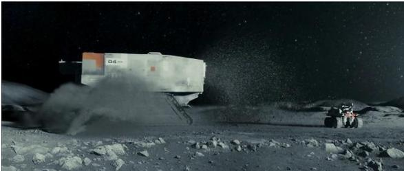
Para extraer el helio-3 atrapado en la primera capa de suelo de la Luna, se han ideado estas máquinas teóricas, una especie de cosechadora, que va abriendo el suelo a su paso, guardando el helio en unos contenedores.
